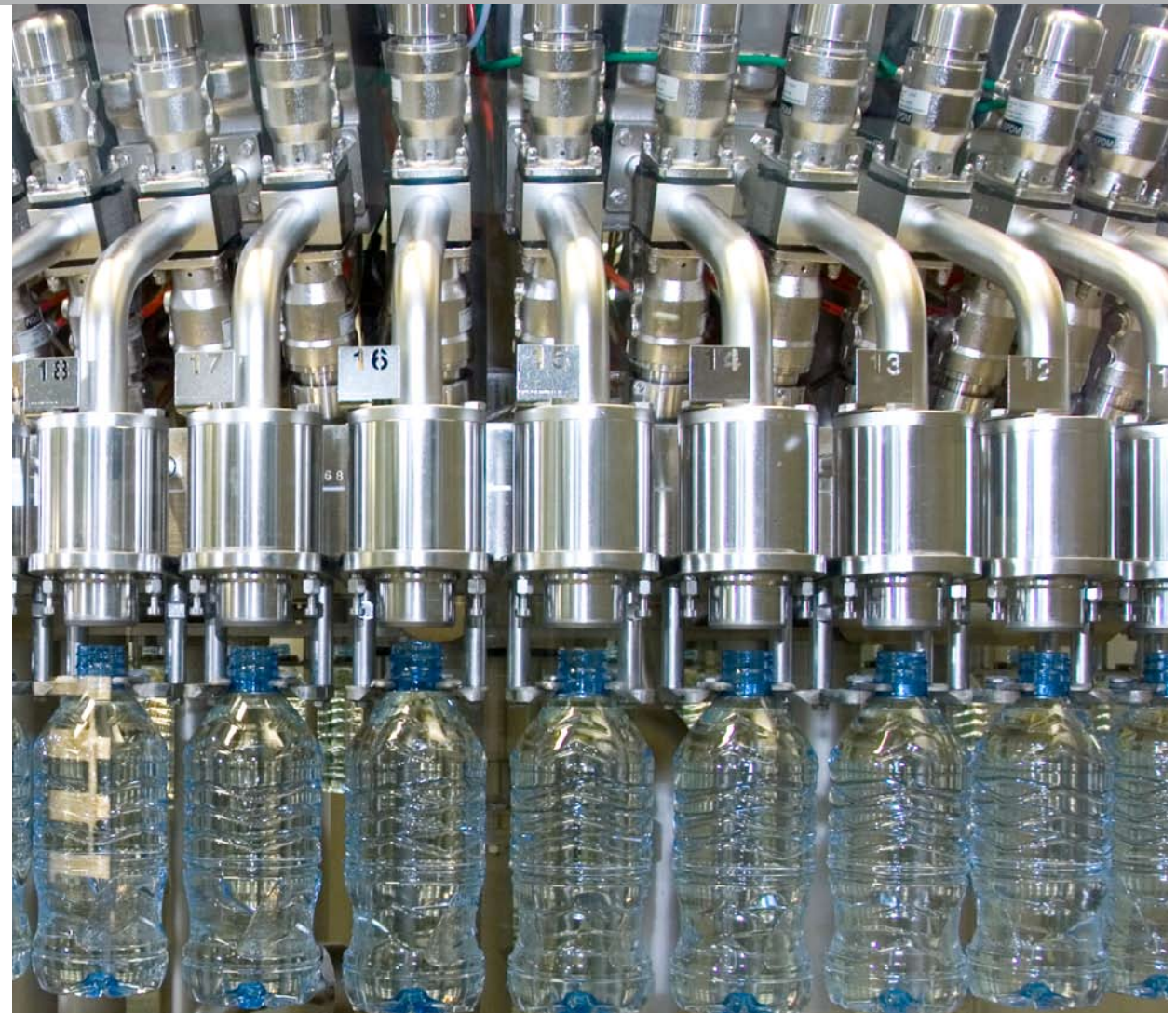
Volumetric VODM-PET con alimentación automática de tulipas CIP
