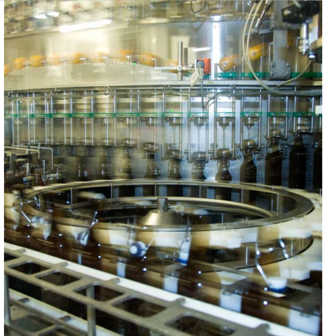
Entrada de envases en la llenadora Sensometric VPL
