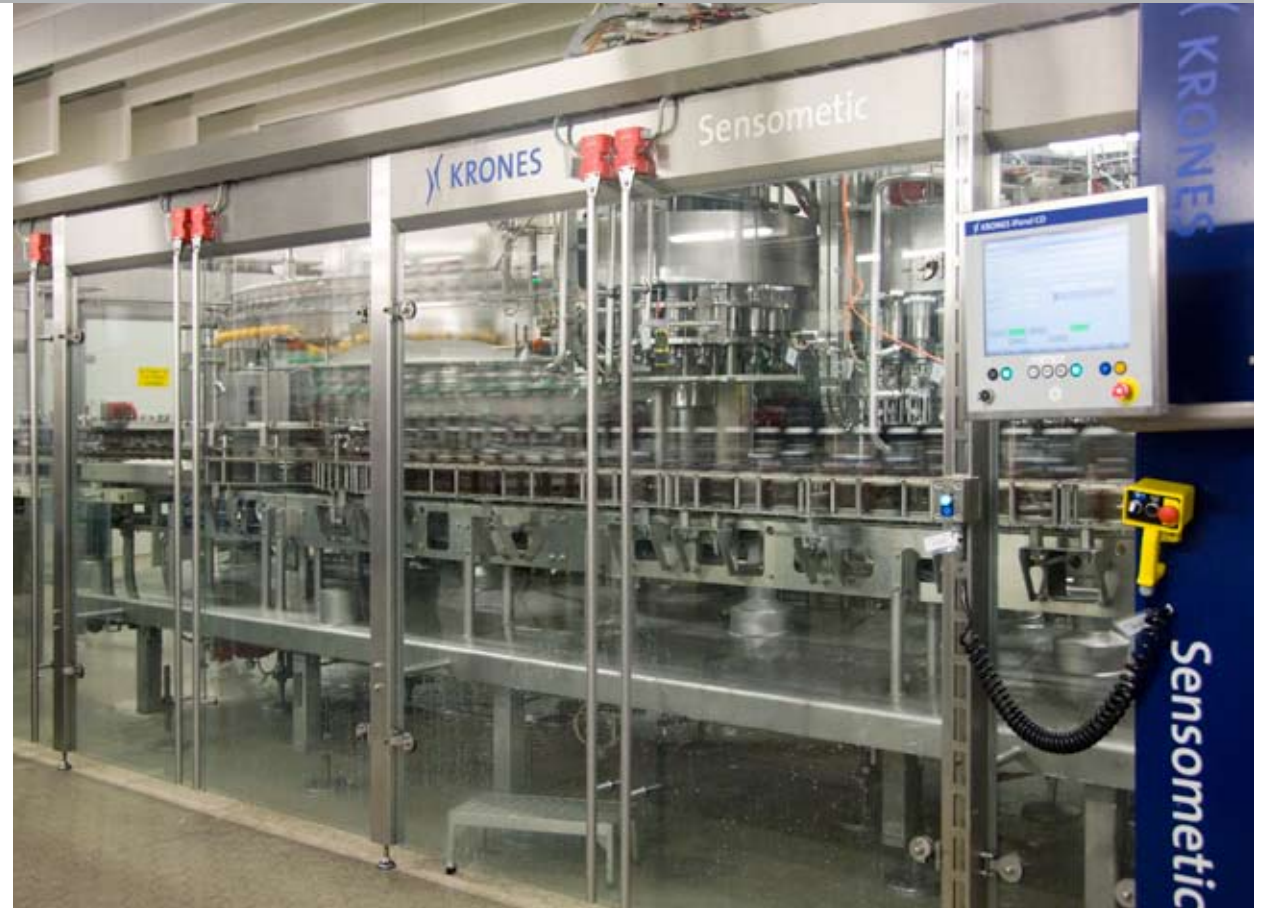
Sensometric VP en ejecución con Roof-Table
