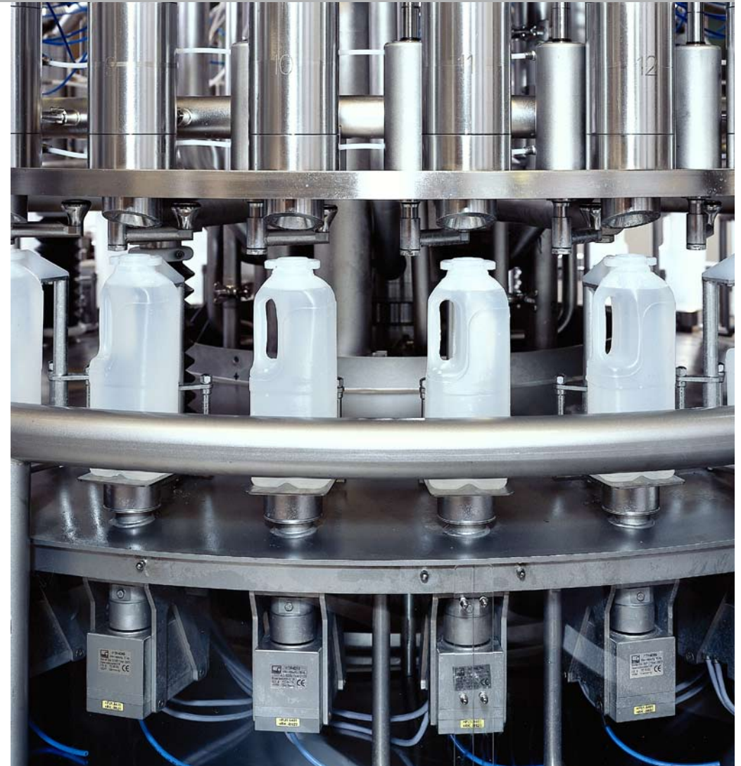
Carrusel de la llenadora con células de pesaje debajo de los platos portaenvases
