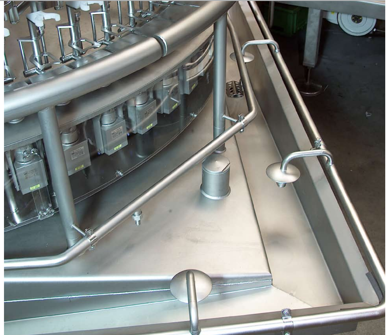
Canaleta colectora para restos de producto
