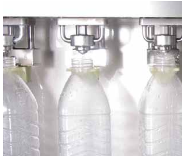
El tratamiento interior de las botellas se realiza mediante las toberas inyectoras con una mezcla de vapor y ácido peracético.
