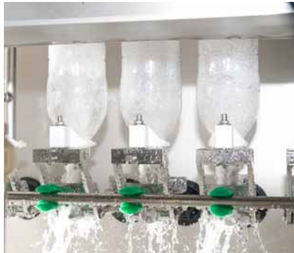
El proceso de enjuague de las botellas con procedimiento de chorro
