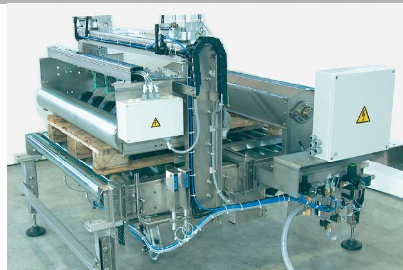
Control de presión de palets vacíos
