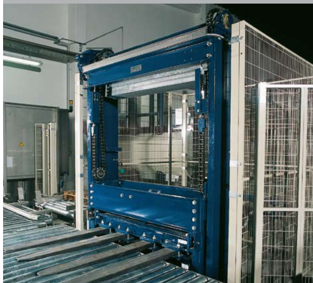
Almacén de palets vacíos LPM-EE
