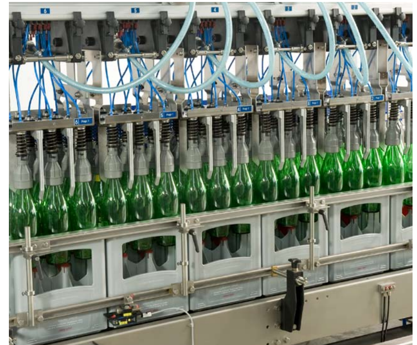
Cabezal de agarre fijo para sacar botellas de vidrio de embalajes retornables
