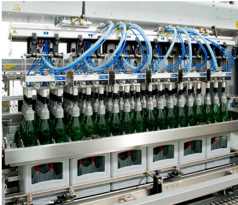
Cabezal de agarre con posibilidad de tracción en un sentido para la colocación precisa dentro de los embalajes
