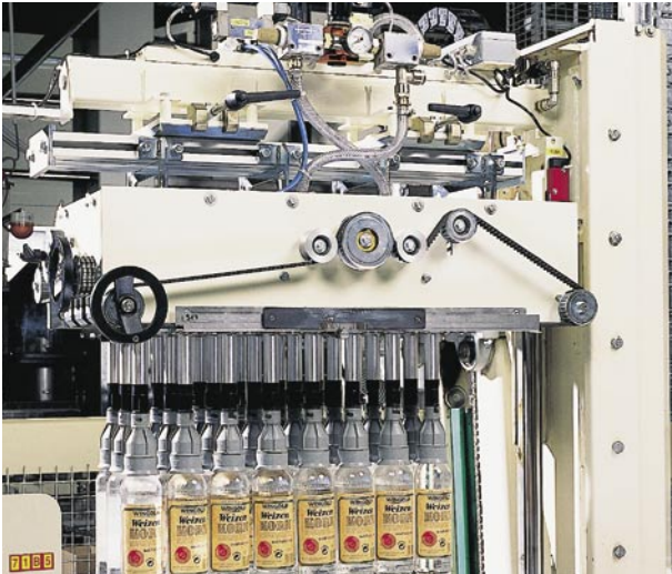
Cabezal de agarre con posibilidad de ajuste mediante husillos
