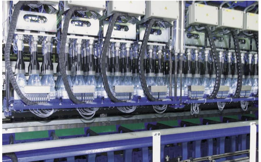
Orientación de botellas PET según su etiqueta
