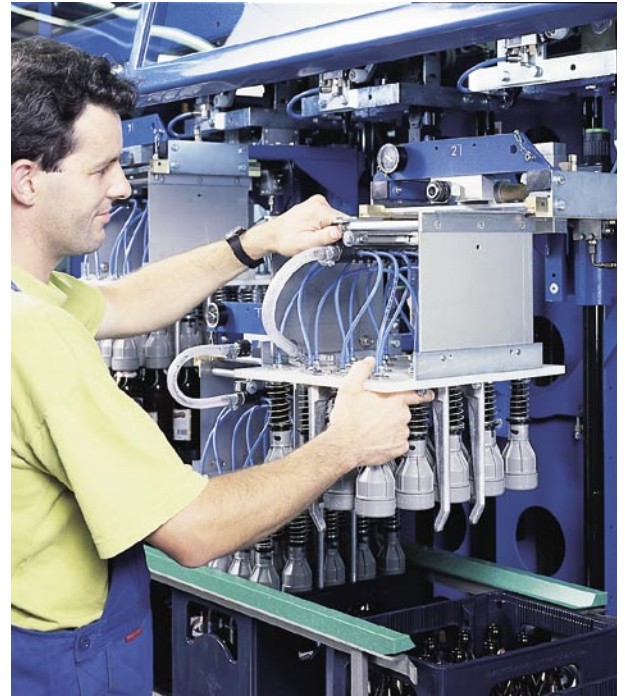
Cambio rápido y sencillo del cabezal de agarre
