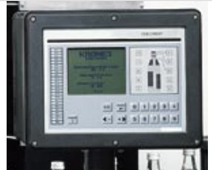
Checkmat 707 F-X: Bedienfeld mit Anzeige über LC-Terminal
